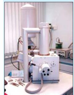
Abb. 4: Rasterelektronenmikroskop (REM)
